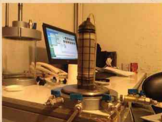
شکل (۳) نمونه ی آماده سازی شده برای تست سه محوری
