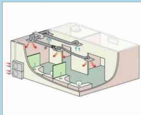
شکل ۱۴: نحوه کارکرد سیستم Duct Split
